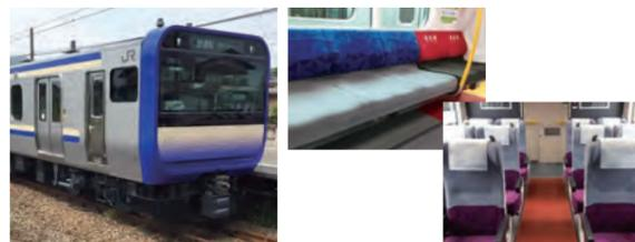
JR東日本横須賀・総武快速線に導入する新型車両E235系が、2020年12月21日より運行を開始しました。普通車のシート表皮材にポリエステルのリサイクル糸を使用したニットを、車両座席クッション材に当社「スミキューブ®」を採用いただいています。「スミキューブ®」は、長期間使用後もリサイクルが可能な環境にやさしい製品です。また、燃焼時にシアンガスなどの有毒ガスが発生しない安全な素材で製造されているため、廃棄時に大気を汚染しないという特長もあります。近年、環境配慮型商品の購買意識の高まりに伴い、多くの鉄道車両で採用いただけるようになりました。
